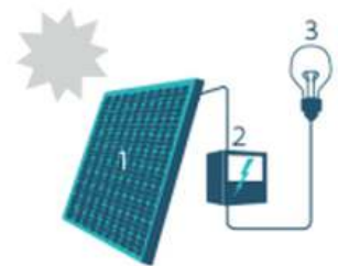
1. Zonnepaneel | 2. Omvormer | 3. Elektrische toestellen
